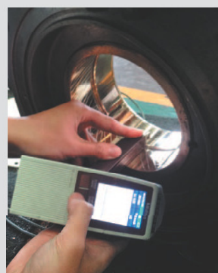
運轉精度的確保，是建立在工件尺寸與表面光度的提昇，對於曲軸&軸銷表面光度與合銅內部表面光度加工品質嚴格要求。
